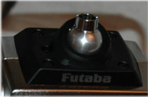
L'antenne se fixe sur une rotule, permettant son orientation, comme sur la T9Z, mais plus souple en rotation.
