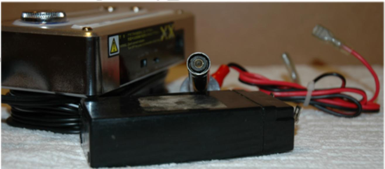
*Ici un exemple du montage à effectuer pour utiliser le chargeur avec un accu au plomb de 2V.*
