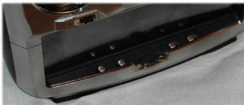
La roulette est très pratique, elle peut sur l'écran d'accueil permettre de se déplacer dans les différents « cadres », en appuyant dessus, on obtient l'équivalent d'une pression sur l'écran comparable au clic gauche d'une souris. Elle permet aussi de changer les valeurs dans les différents paramètres, comme par exemple, celles des points d'une courbe. Cela plus aisément qu'avec les « boutons logiciel » à presser depuis l'écran tactile qui incrémente par pas de 2, 5 ou 10 ...
