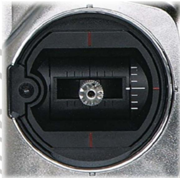
Ici, les vis que l'on règle pour le « ressenti » du crantage, ainsi que la retenue lors du déplacement (Photo 1). Sur la photo 2 se trouve la vis de réglage pour l'inclinaison extérieure du manche.
