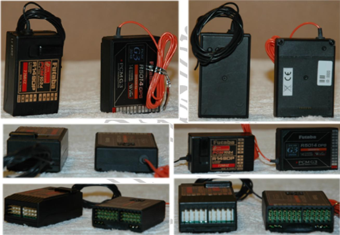
Le poids est presque similaire, 33 gr pour le 149DP et 31 gr pour la R5014DPS. Il est appréciable que pour une telle avancée technologique le poids soit réduit. On n'arrête pas le progrès ! :-)
